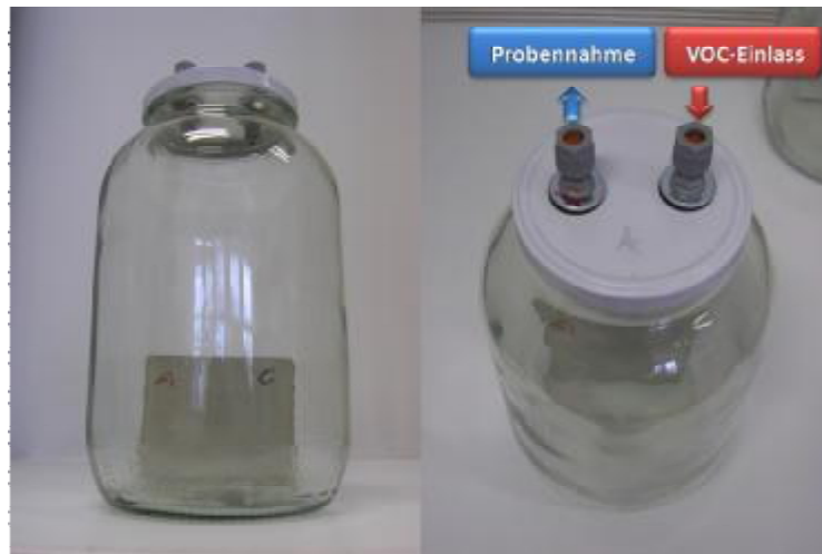
Abbildung 3: Prüfkammern zu Untersuchung der Sorptionseigenschaften von Putzen gegenüber VOCs
